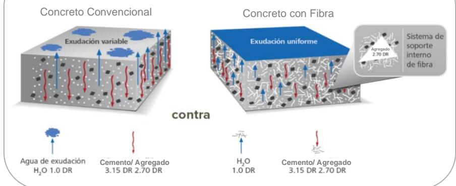
Los filamentos funcionan como soporte interno y agente estabilizador ante los diferenciales de densidad de los componentes del concreto, además de aportar un refuerzo tridimensional en edades tempranas.
